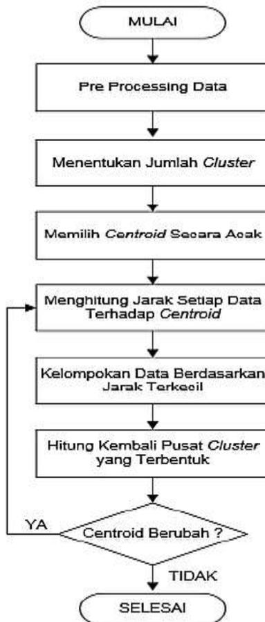
Gambar 2.1 Diagram alir algoritma *K-Modes*
